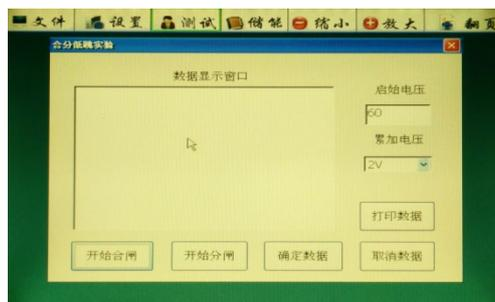
(6)、**重合闸测试菜单**：可做断路器的分合、合分、分合分三种重合闸实验。
