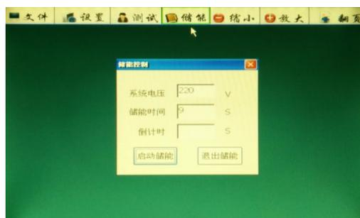
(2)、**储能测试菜单**：测量储能电机的功率及储能时长。如下图：
