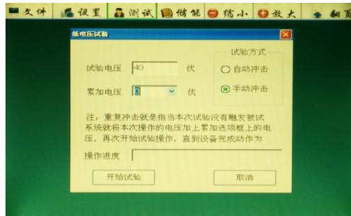
①、**手动冲击**：首先设置试验电压和累加电压（电压幅值），手点击**开始试验**菜单，
