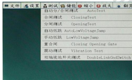
(1)、**自动分/合闸测试菜单**：测量普通断口，自动识别断口状态做出相应的动作。
